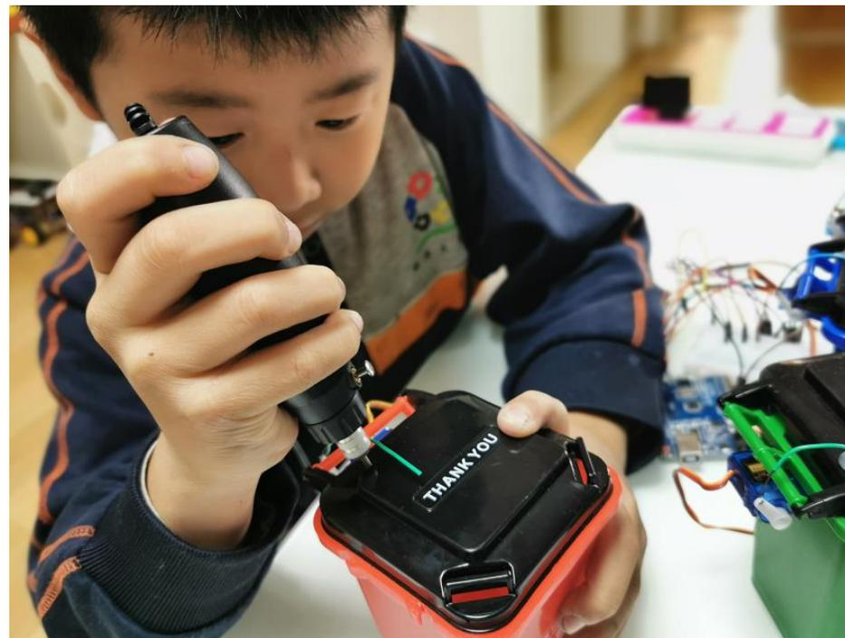
在垃圾桶盖上打孔，用细铁丝连接舵机转轴
